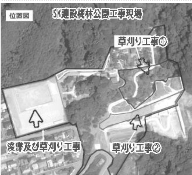
図説明：草刈り工事①②は急傾斜地とされた箇所
